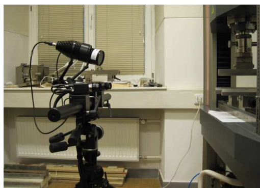
Obr. 4 Kamery systému ARAMIS připravené ke snímání experimentu
